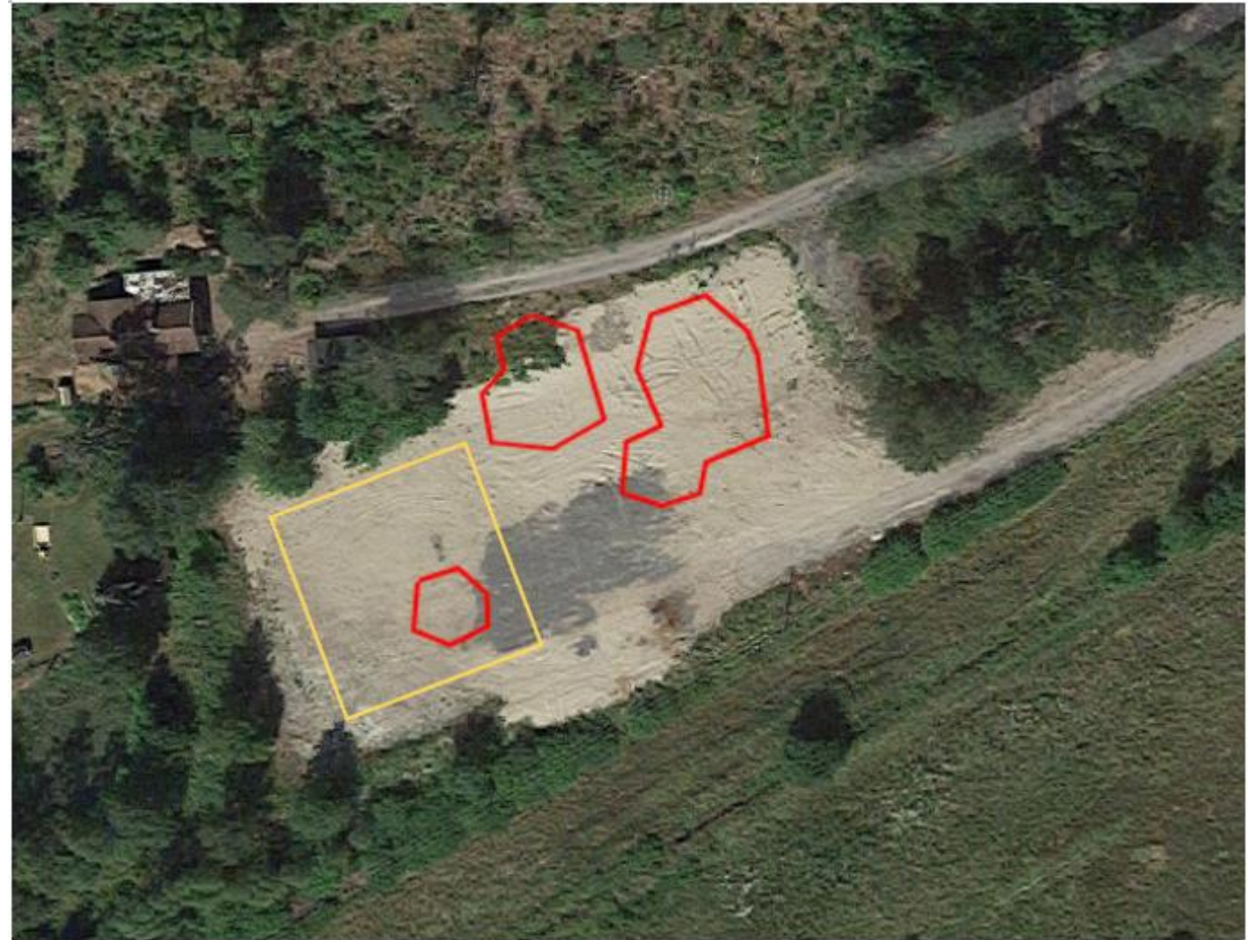
Kuva 23. Massanvaihtokaivantojen (punainen) ja välivarastointialueen (keltainen) suuntaa antavat sijainnit.
