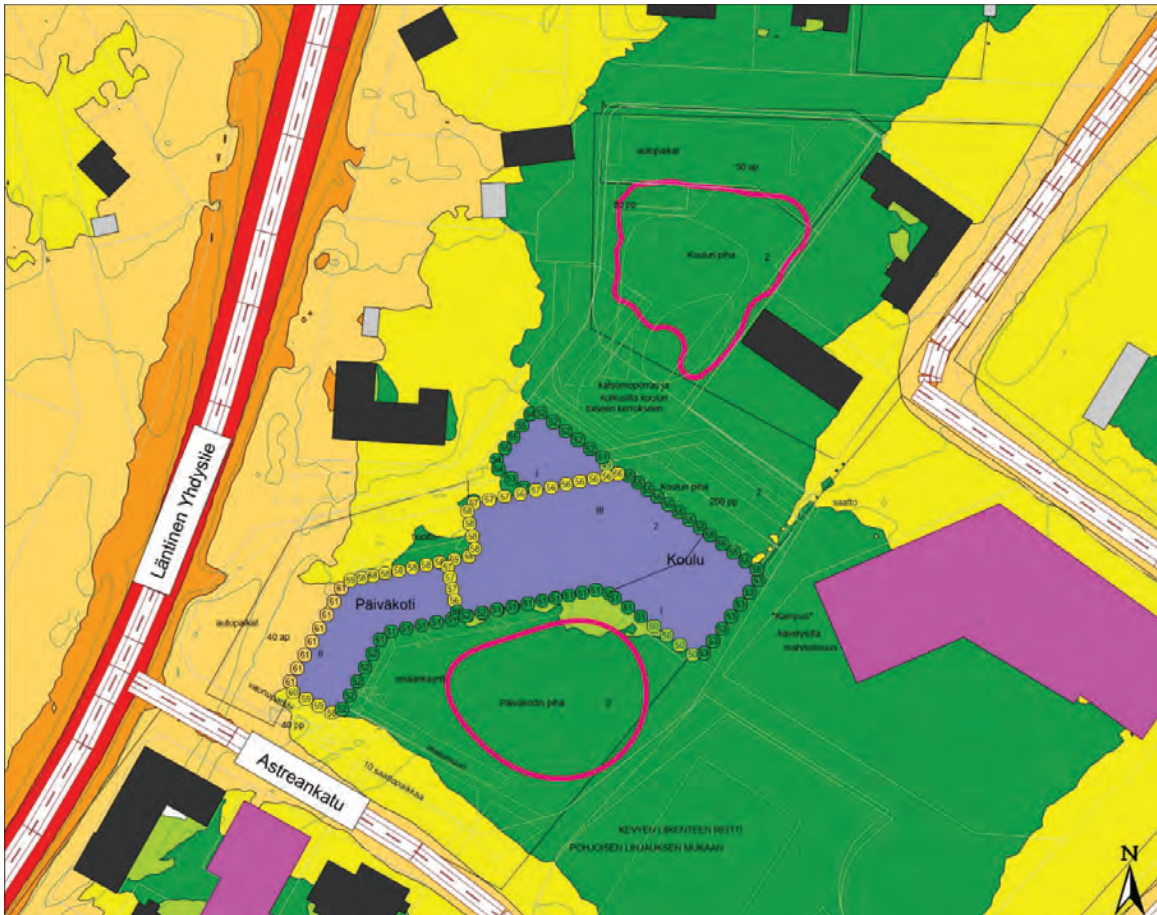
Kuva 18: Luonnosvaiheen massoitteluvaihtoehto B:n mukaiset ulkoalueiden melutasot ja julkisivuille kohdistuvat suurimmat tie- ja raideliikenteen melutasot ilman julkisivuheijastusta (A-Insinöörit Oy, 22.12.2023)
